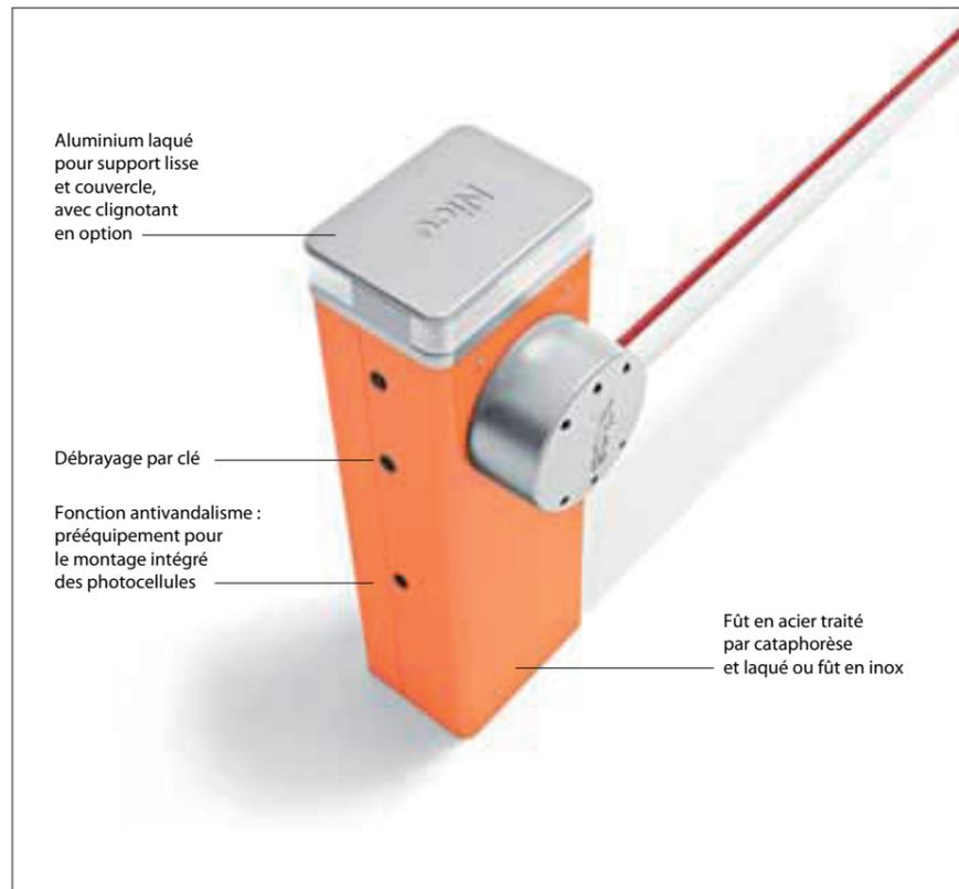
Système de barrière levante électromécanique pour le contrôle des accès routiers.
